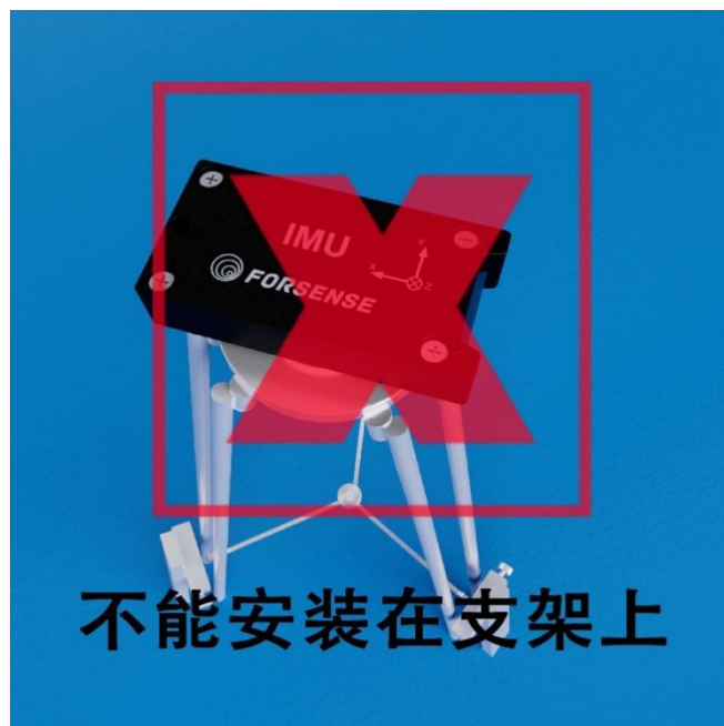
图 11 安装错误示意图
