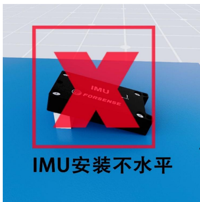
图 8 安装错误示意图
